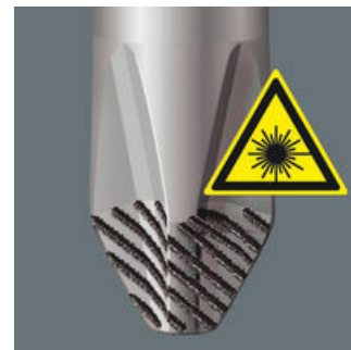
À l'aide d'un laser extrêmement concentré, on génère une structure superficielle acérée. La dureté des stries réalisés par ce procédé atteint jusqu'à 1000 HV 0,3. Wera Lasertip s'agrippe dans la tête de vis et empêche le dérapage hors de celle-ci. Pour vis à fente, Phillips et Pozidriv.
