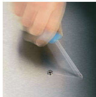
Riper hors de la vis est chose courante lors du vissage. Il arrive même que l'on endommage au passage des surfaces coûteuses, voire que l'on se blesse. La pointe des tournevis Wera Lasertip fait l'objet d'une découpe striée microscopique par rayon laser. Cette surface rugueuse vient littéralement "mordre" dans la tête de vis. Fini les dérapages intempestifs !
